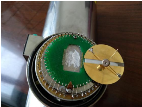
图4 键压宝石片后的杜瓦
