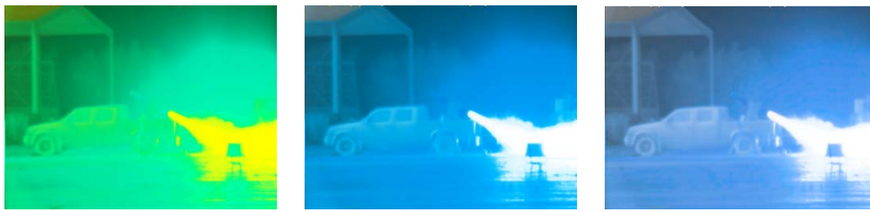
图2 场景一 Toet 假彩色融合 (左: 原算法; 中: Toet 改进算法; 右: 本文改进算法)
