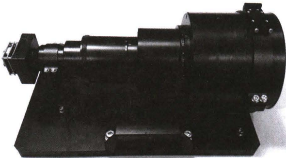
图 1 铟镓砷相机结构 Fig.1 InGaAs camera structure
