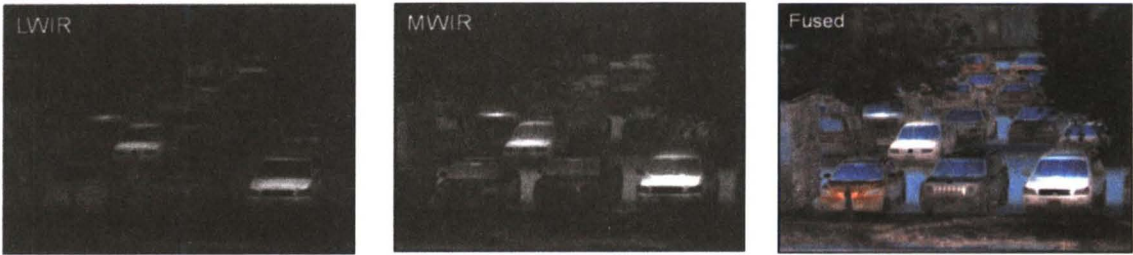
图 9 图 7 系统的长波红外 (左图)、中波红外 (中图) 图像及其融合图像 (右图)
