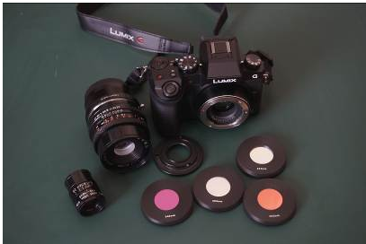
图 11 紫外成像设备各器件及组成
