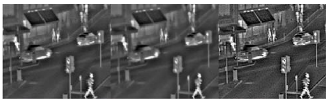
(a) 红外图像 (b) 平滑图像 (c) 增强后图像 (a) Infrared image (b) Smooth image (c) Enhanced image
