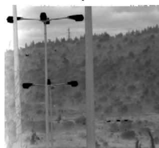
图10 640 \times 512 \text{ } 15 \mu\text{m} InAsSb n型焦平面阵列 150 K 温度下的热像图
