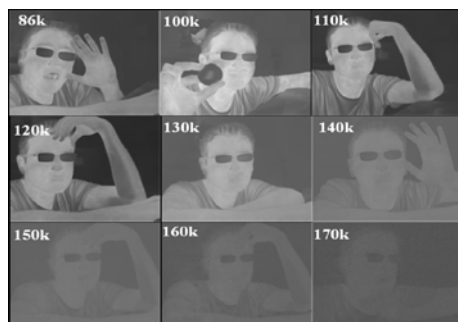
图 12 HOT 器件在不同温度下的热像图
