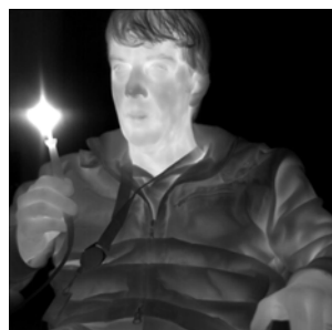
图9 1 \text{ k} \times 1 \text{ k} InAsSb 焦平面阵列 150 K 温度下热像图 ( f/2.3 )
