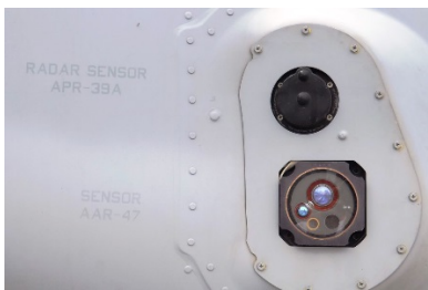
图 2 安装在鱼鹰飞机上的 AAR-47 系统
