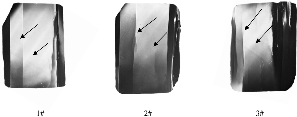
图 1 连续衬底片的 X 射线形貌图 Fig.1 X-ray morphology of CZT continuous slice
