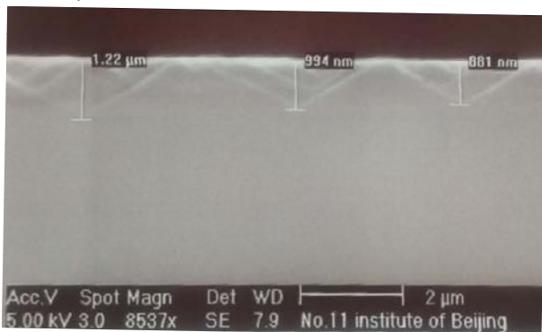
图 1 CZT(211)B 衬底横截面的 SEM 图
