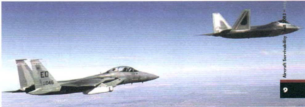
图 10 飞行中 F-22 的红外信号测试(从左到右: 挂载吊舱的 F-15B, F-22 测试机) Fig.10 F-22 in-flight infrared signature measurements (left to right: F-15B and F-22 test aircraft)
