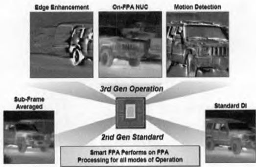
图3 灵巧红外焦平面探测器可实现的图像处理功能
