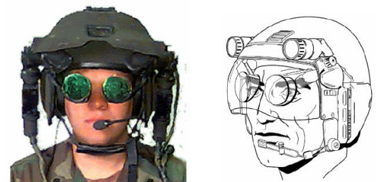
图 11 双图像源合像的常见产品形式 Fig.11 See-through display in binocular design
