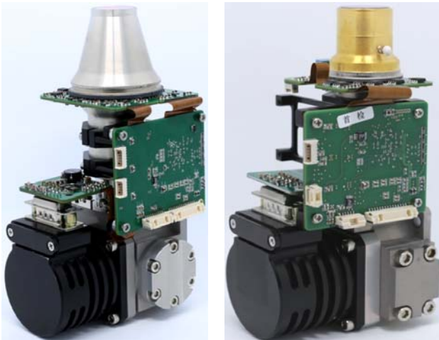
图 19 640×512 中波数字成像组件照片 (左：25 μm 像元间距；右 15 μm 像元间距)
