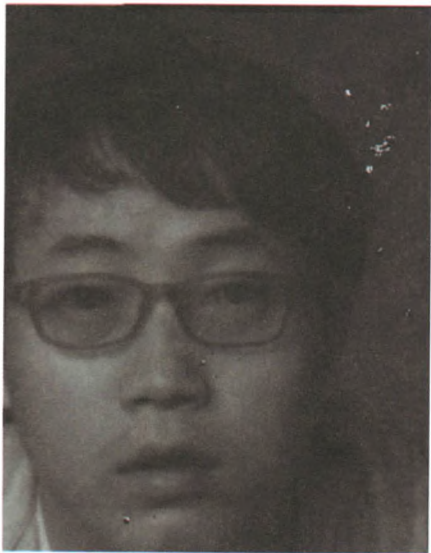
图8 InP/InGaAs 宽光谱探测器对人脸的成像效果
