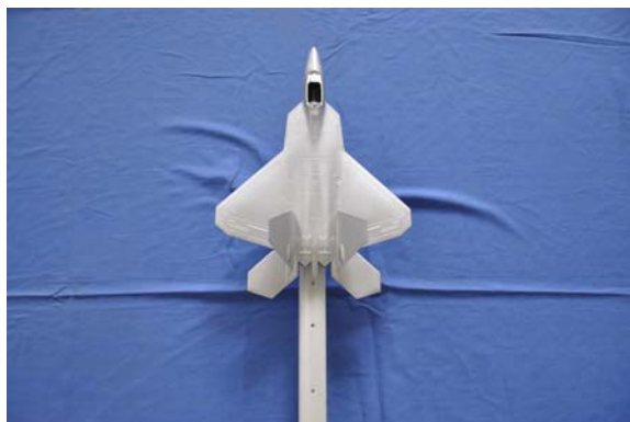
图4 伪装飞机缩比目标
