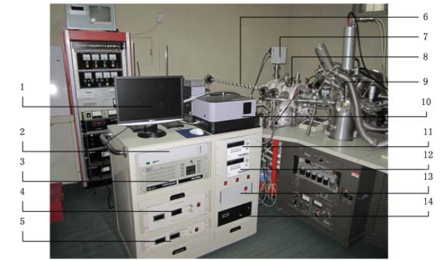
1.显示器; 2.四极质谱仪控制箱; 3.主机; 4.微弱信号处理模块; 5.光谱响应电源; 6.磁力传输杆; 7.四极质谱仪; 8.超高真空激活腔室; 9.表面分析系统; 10.光栅单色仪; 11.Cs 源程控电流源; 12.O 源程控电流源; 13.汞灯电流源; 14.斩波器电源
