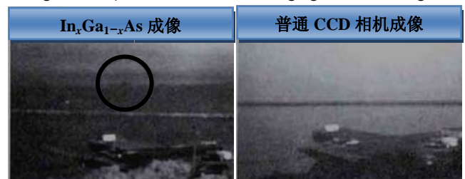
图 7 雾天 \text{In}_x\text{Ga}_{1-x}\text{As} 成像器件与普通 CCD 相机成像对比图
