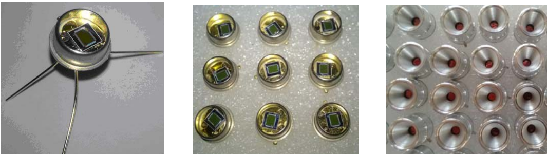
图 2 TO-39 封装的 MEMS 红外光源器件 Fig.2 MEMS infrared source device of TO - 39 package
