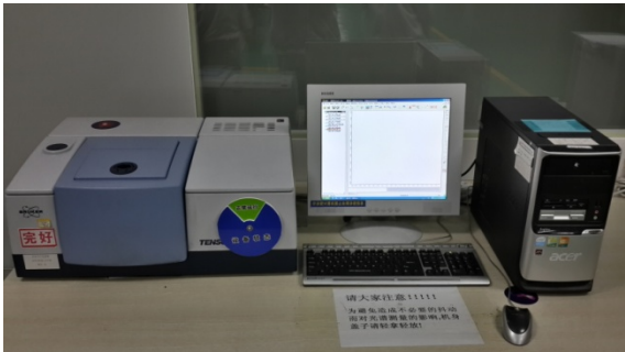
图6 傅里叶红外光谱仪 Fig.6 FTIR spectrometer (BRUKER TENSOR 27)
