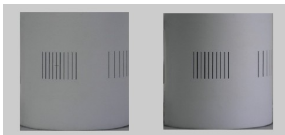
图6 有缺陷时的图像检测
