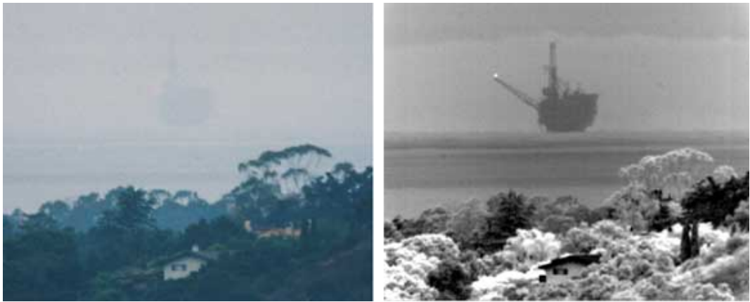
图 4 47 km 距离的海洋轻雾霾条件下的采用可见光 (左) 和 SWIR (右) 成像观察的油井图像的对比
