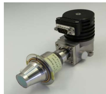
图 5 中波 320×256 元探测器组件
