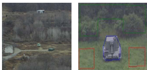
(a)实验用的军用车辆及其 所处的背景环境 (b)偏振成像效果图
