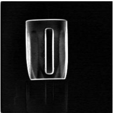
图10 加热玻璃杯灰度（左）和偏振度（右）图像
