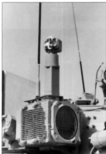
图2 安装在 BMP-3 战车上的 Shtora 系列 EADS 防御系统 Fig.2 A Shtora sensor element mounted on a BMP-3 IFV (seen at IDEX 2006)
