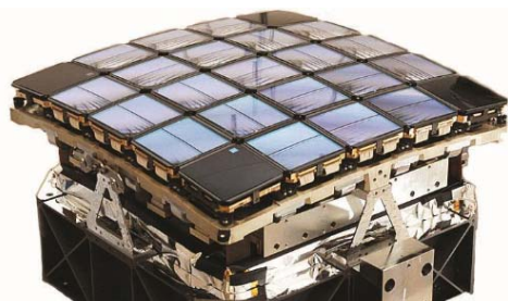
图8 凝视型焦平面探测器拼接示意图
