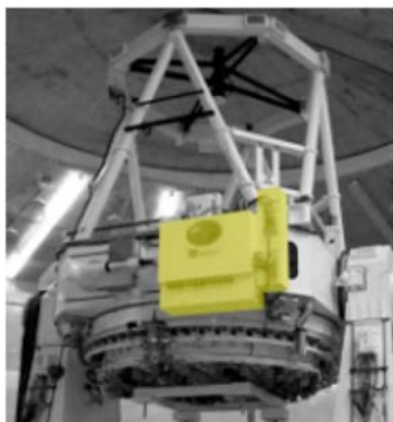
(a) ARS 安装于 3.67 m 望远镜的四通上
