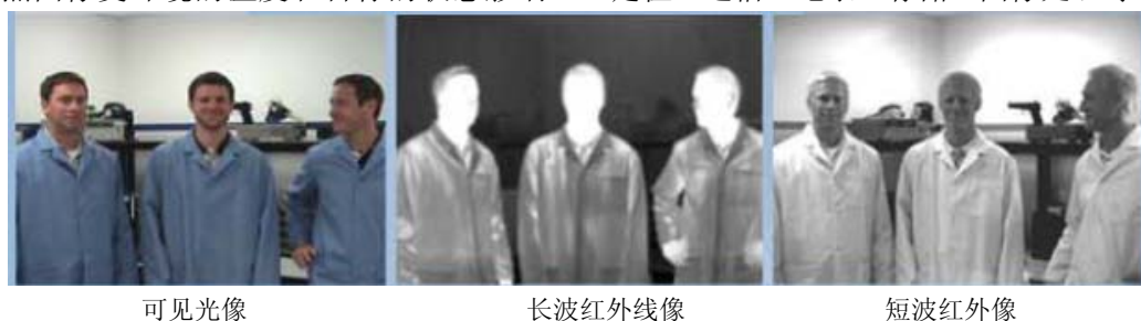
图5 用不同波段光拍摄的像之比较
