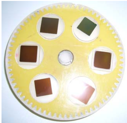
图 3 PZT 热释电晶片 Fig.3 PZT Pyroelectric wafer
