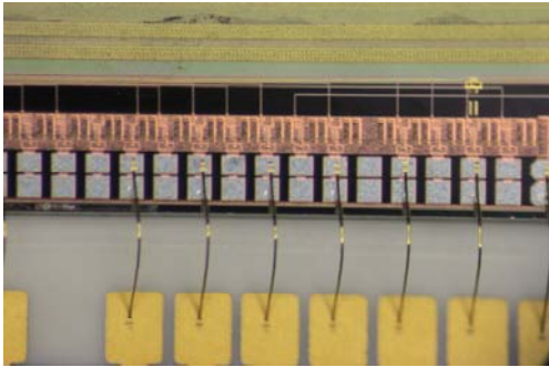
图 4 焦平面探测器超声楔键合
