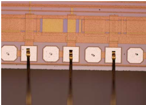
图 11 规范楔键合示意图 Fig.11 Standard wedge bonding
