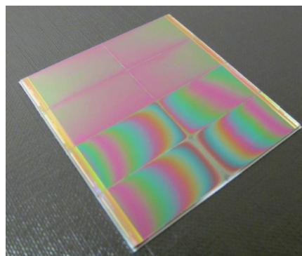
图 5 Selex 公司 8 个 HD1920×1080 拼接阵列 [9] Fig.5 Selex Corporation 8 HD1920×1080 detector arrays [9]
