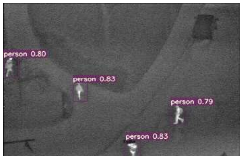
(e) YOLOv7s 在夜间下的检测效果 (e) YOLOv7s detection effect at night
