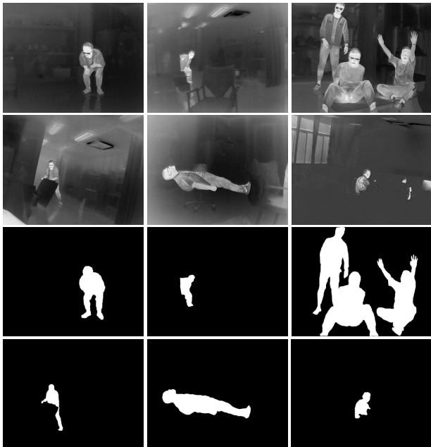
图 4 自建训练集数据：上 2 层为热红外图像，下 2 层为标记图（GT）
