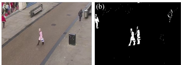
(a) 原始图像 (b) ViBe 算法 (a) Original image (b) ViBe algorithm
