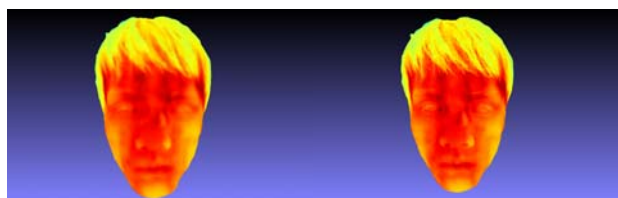
图9 红外图像预处理前(左)后(右)的三维温度场重建结果
