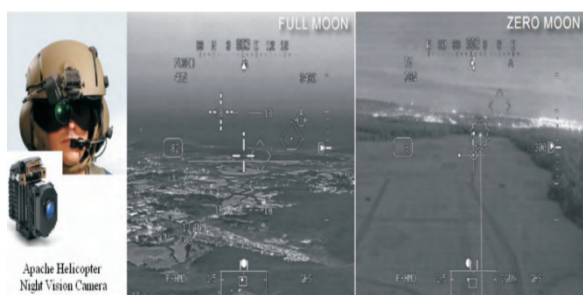
图 12 用于阿帕奇武装直升机的 EBAPS 相机及夜间 (满月、无月) 成像效果 [19] Fig.12 EBAPS camera used for Apache gunship and night (full moon, no moon) imaging effect [19]
