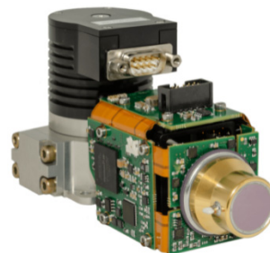
图 3 瑞典 IR Nova 开发的 Freja330 气体探测器 [11]
