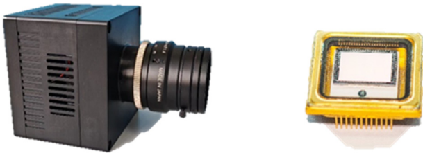
图 14 偏振成像模组（左）及偏振 EMCCD 器件（右）
