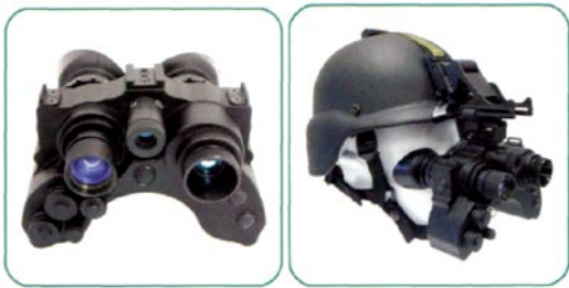
图 12 DSQ-20 彩色夜视仪及其头盔安装模式 Fig.12 DSQ-20 color night goggle 合（处理延时可控制在 80ms 以内），提供自然舒适的
