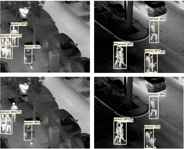
图 5 改进 SSD 与原 SSD 算法在 LLVIP 数据集上的检测结果（上排为改进 SSD 算法的检测效果图，下排为原 SSD 算法检测效果图）
