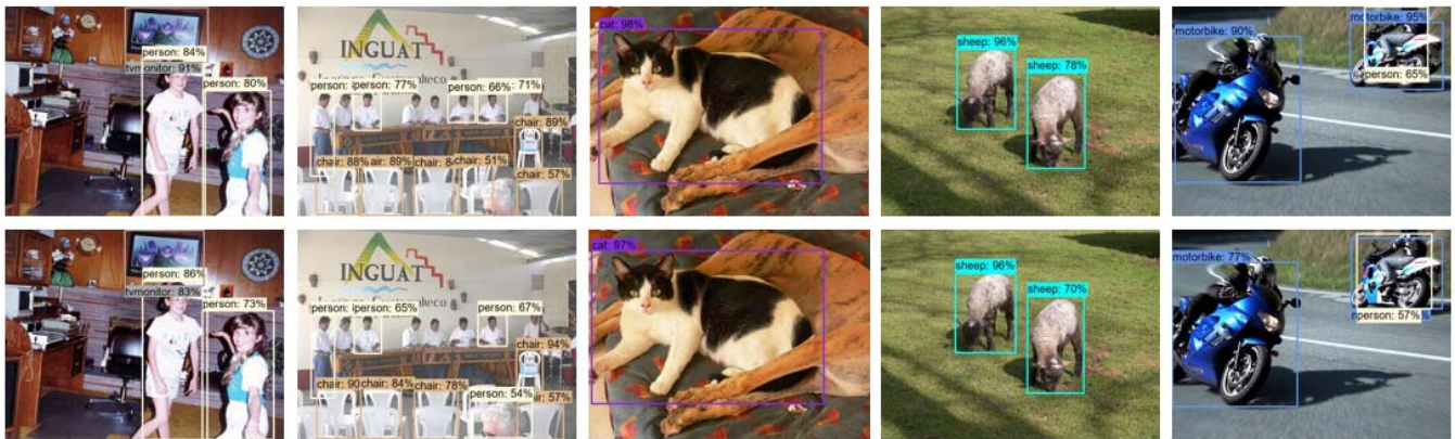
图 4 改进 SSD 与原 SSD 算法在 PASCAL VOC2012 数据集上的检测结果(上排为改进 SSD 算法的检测效果图,下排为原 SSD 算法检测效果图)
